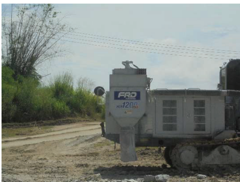
รูปที่ 2-13: รถเจาะรื้อระเบิดที่มีการติดตั้งแผ่นกรองฝุ่น
