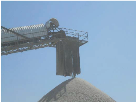
รูปที่ 2-17: เครื่องป้องกันฝุ่นในการเทกองหินคัดขนาดบริเวณปลายสายพานลำเลียง
