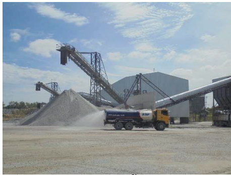
รูปที่ 2-27: การฉีดพรมน้ำบริเวณโรงโม่หิน
