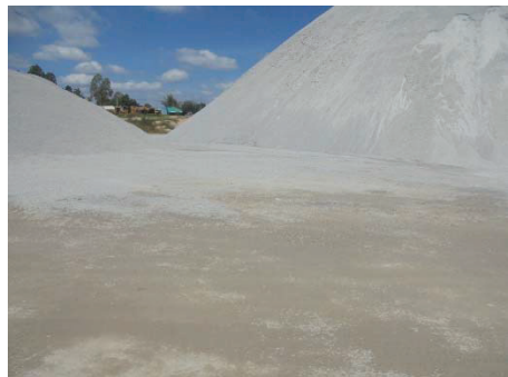
รูปที่ 2-19: พื้นที่เก็บกองหินเป็นลานคอนกรีตหรือหินบดอัดแน่น
